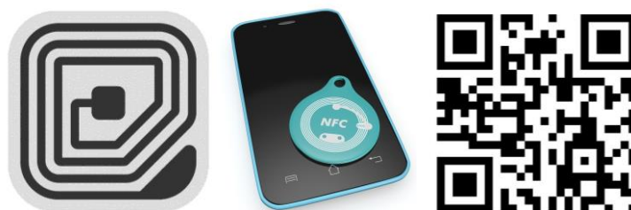
Figura 3. De izquierda a derecha: Etiquetas RFID, NFC y códigos QR comúnmente empleadas para la generación de identificadores únicos, y cómo mecanismos de comunicación de información al consumidor.
